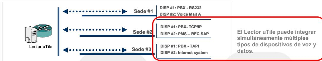
Gracias a la prestación bidireccional se extrae el máximo rendimiento de las características hoteleras de centrales telefónicas y equipos de comunicación, además de conseguir una mayor agilidad para configurar y adaptar el servicio telefónico a los huéspedes y clientes.
